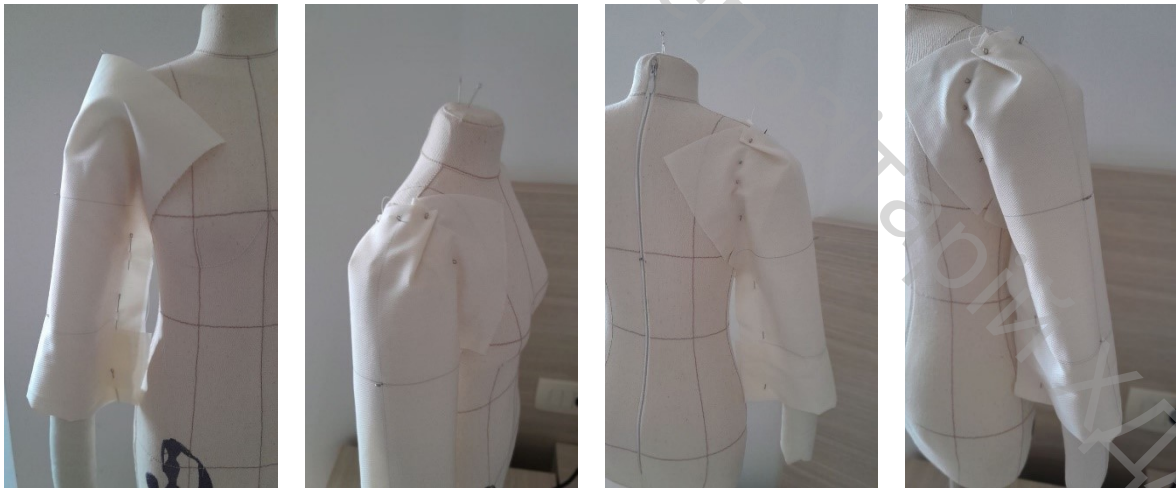
Рис.8 – Послідовність процесу наколювання вшивного рукава.
