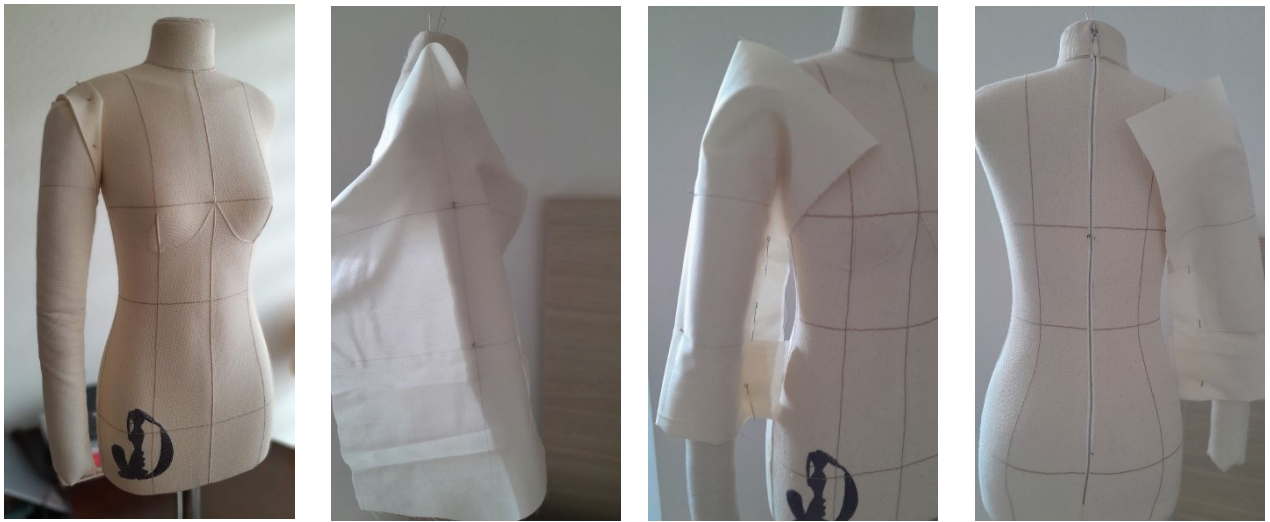
Рис.7 – Послідовність процесу наколювання вшивного рукава.
