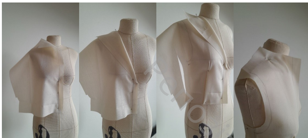
Рис.11 – Послідовність наколювання відкладного коміра піджачного типу.
