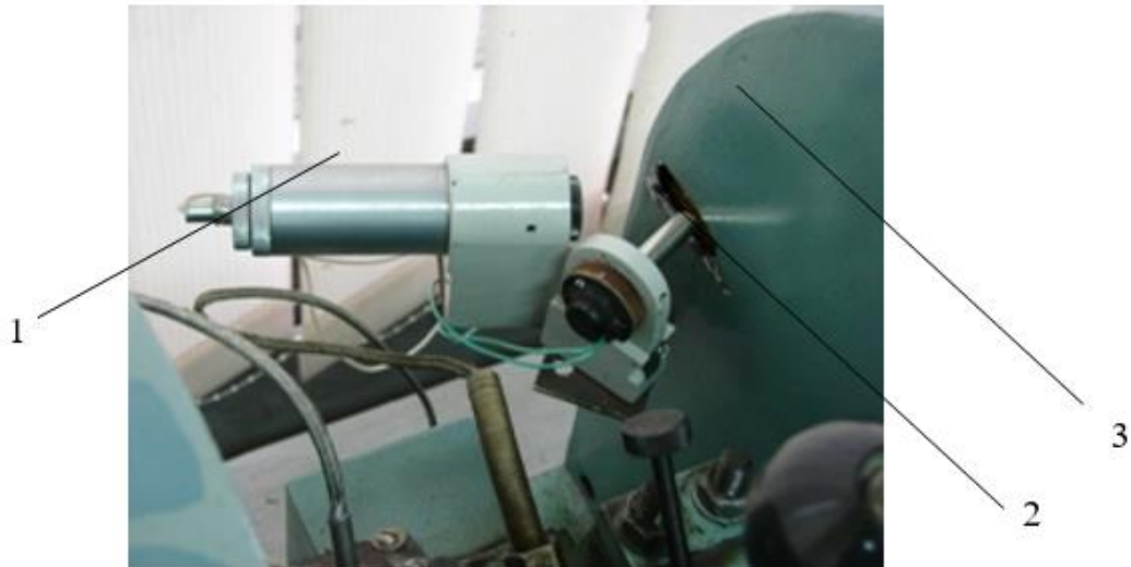
Рис. 2. Блок контролю частоти обертання маховиків. 1- освітлювач, 2- фотодіод, 3-захисний кожух маховиків
