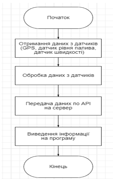
Рис. 6. Алгоритм роботи автоматизованого модуля контролю цільового використання автотранспорту
